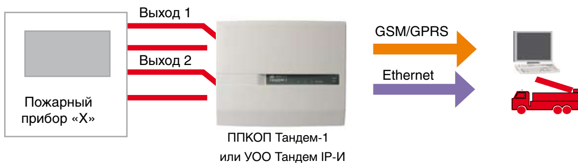
Рис.19. Пример подключения посредством релейных выходов
