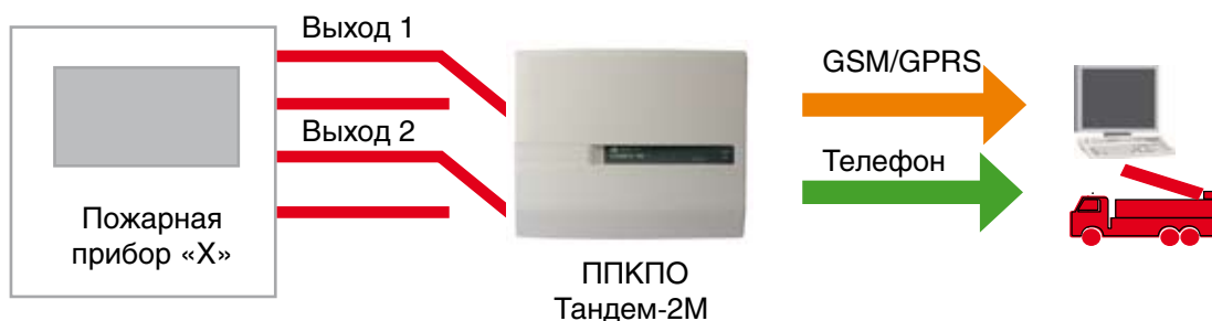
Рис.14. Пример подключения объектового оборудования к ППКОП «Тандем-2М»
